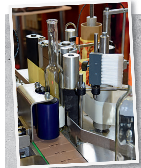
Halbautomatische Etikettiermaschine „Gabrielle“ von Elvo Coding.
